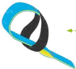
JOKER LIGHT en tête d'alouette = Rupture 2475 daN
