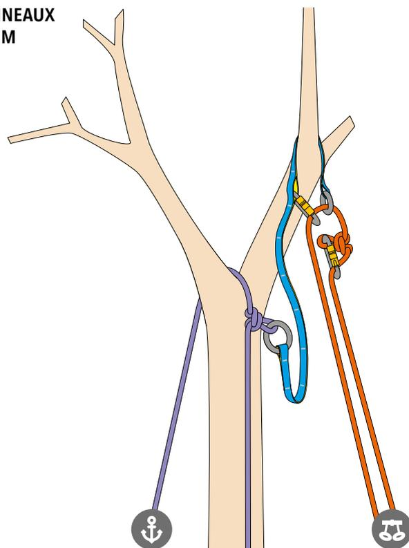
Connexion de l'ancrage principal à la corde d'accès,
