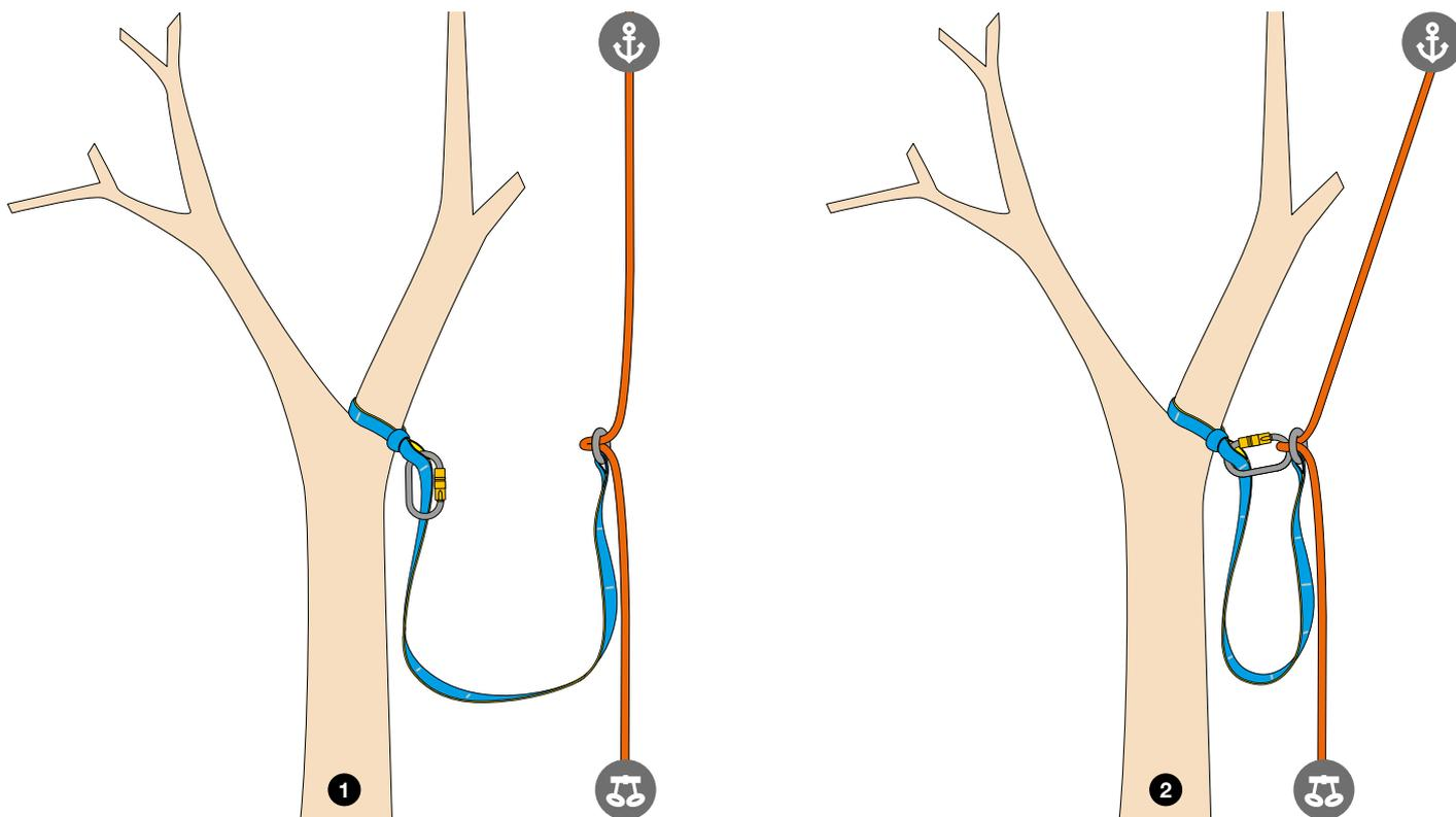
❶, ❷ et ❸ : mise en place de la redirection SRT avec anneau intégré à l'ancrage.
