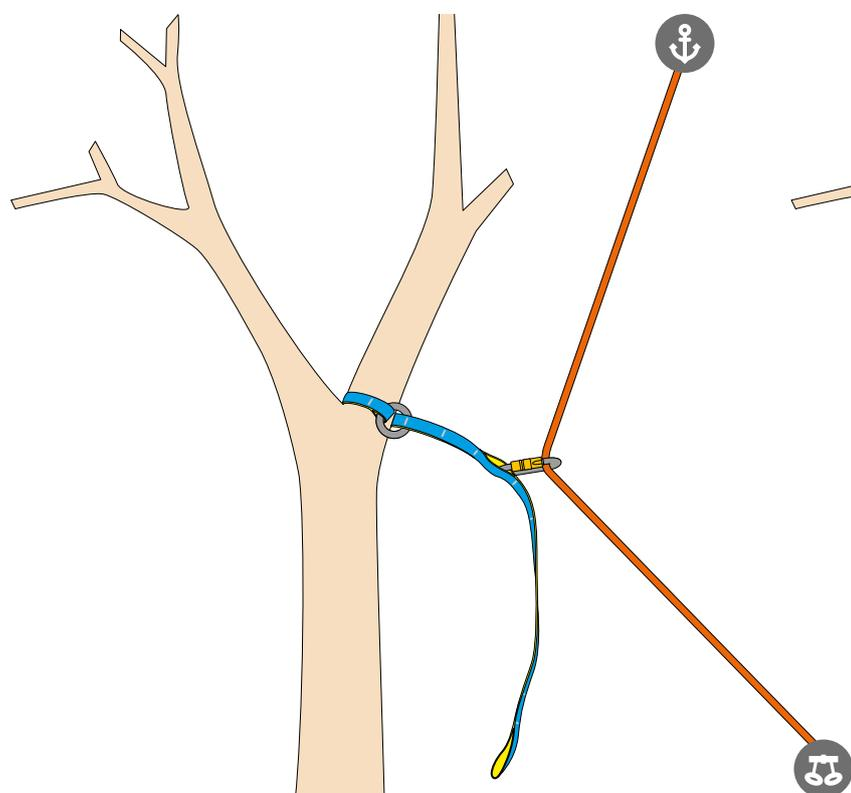
Redirection SRT simple, passage de la corde dans un connecteur.
