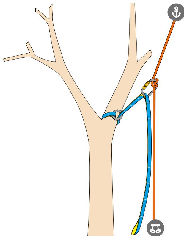
Redirection SRT avec nœud demi-cabestan. Permet d'ajuster la tension avec le point d'ancrage principal.
