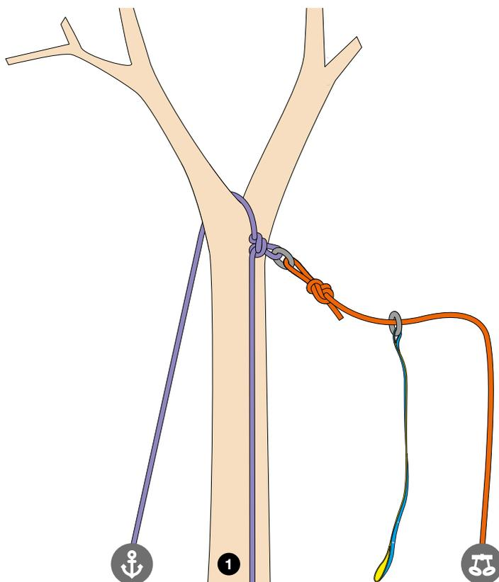
1, 2 et 3 : mise en place de la connexion de la corde de travail au rappel d'accès.
