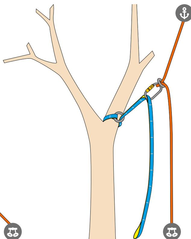
Redirection SRT avec ajout d'un anneau. Permet d'ajuster la tension avec le point d'ancrage principal.
