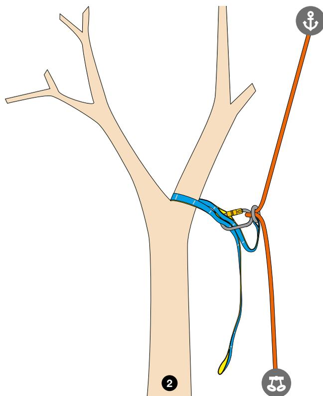
❶ et ❷ : mise en place de la redirection SRT, ancrage en double, et anneau intégré.
