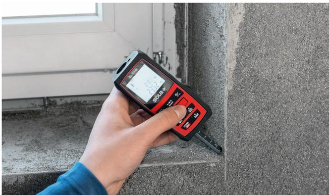
Déterminez aussi bien des distances minimales que maximales en mesurant la distance la plus courte ou la plus longue entre 2 points, par exemple la diagonale. L'embout multifonctionnel et déployable du VECTOR 80 facilite les mesures précises dans un coin ou un interstice.
