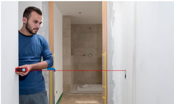
Le VECTOR 20 mesure des distances entre deux points et est doté de la fonction de mesure continue. La mesure s'effectue en quelques secondes de façon très précise et pratique.
